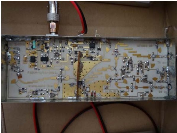
Détail du transverter 10 GHz (à gauche), et de son PA (à droite)
